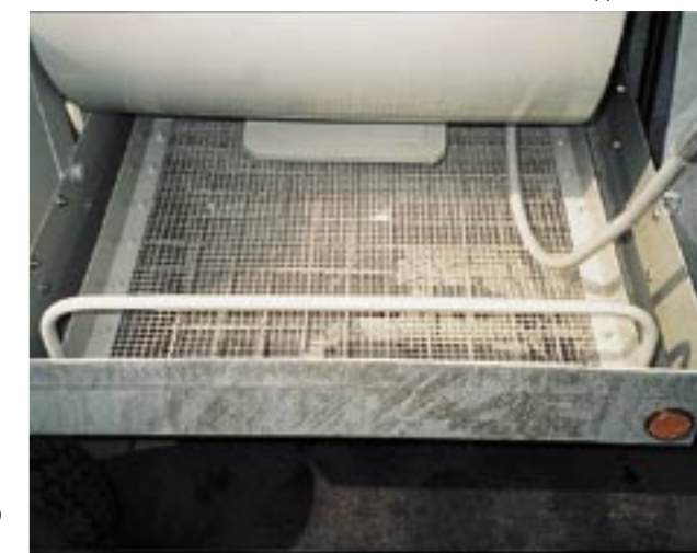
El tamiz tiene un accionamiento vibratorio mecánico y está alojado dentro de la tolva de mortero galvanizada. Puede sacarse para limpiarlo.
