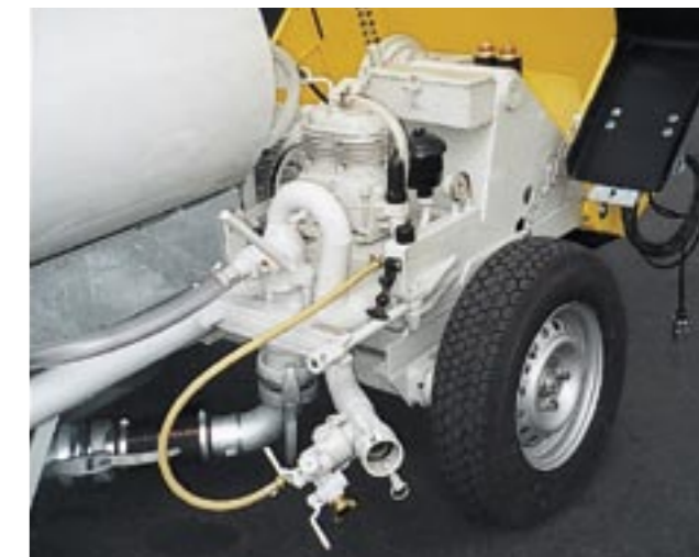
El motor, la bomba de émbolo y el compresor están bien al alcance debajo de la tapa, de apertura amplia.
